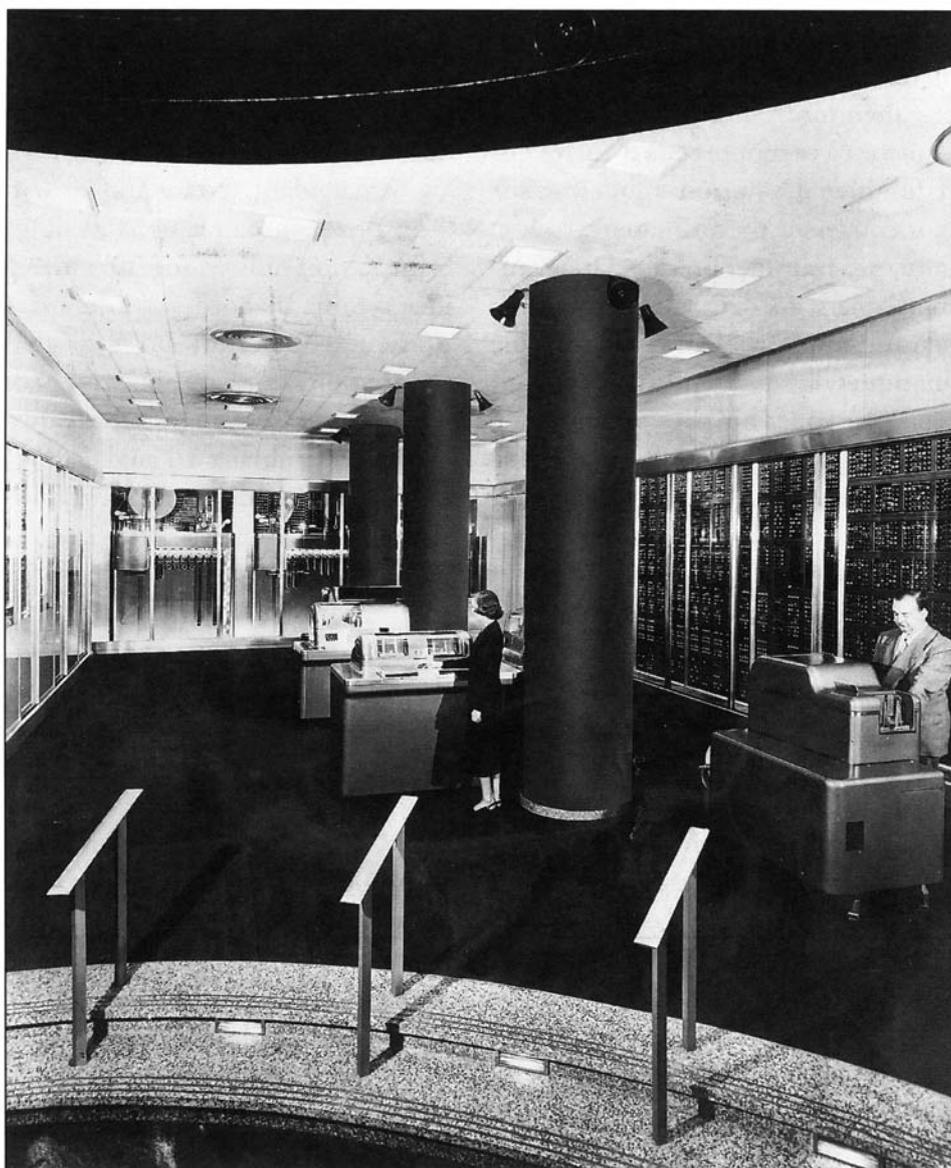
*Le Selective Sequence Electronic Calculator d'IBM, mis au point en 1947, comportait à la fois des tubes à vide et des relais. Il multipliait 100 fois plus rapidement que Mark 1. C'était le premier ordinateur IBM à programme enregistré. Il pouvait, par sélection des instructions en mémoire, déterminer la séquence de calcul appropriée au problème posé, d'où son nom.*
