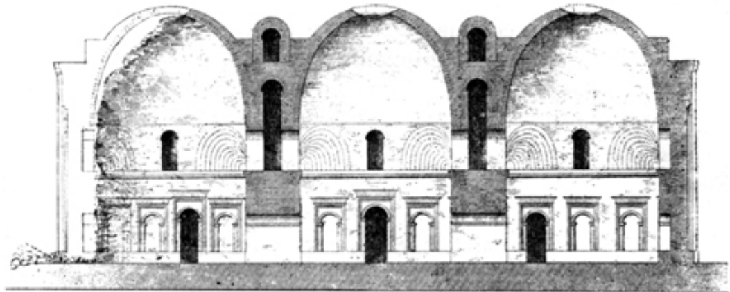
Fig. 421 . Coupe du palais représenté page 744 (fig. 420). D'après Flandin.
