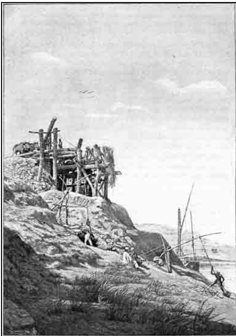
Fig. 152. Schadouf, instrument employé pour puiser de l'eau dans le Nil et irriguer le sol. D'après une photographie.
